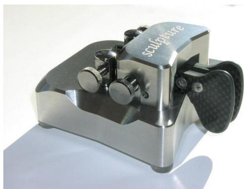
La lettera C ad esempio è ottenuta facendo squeeze linea-punto e rilasciando entrambe le palette quando la C è stata emessa completamente dal manipolatore. La F si ottiene invece premendo la paletta dei punti, poi sfiorando appena la paletta
