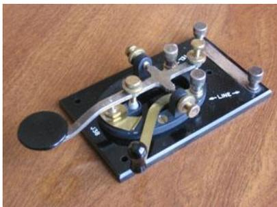
Tasto verticale modello **J38**, un tasto usato dalle forze armate U.S. utilizzato durante la II° guerra mondiale e poi usato frequentemente dai radioamatori. Tasto manuale.
