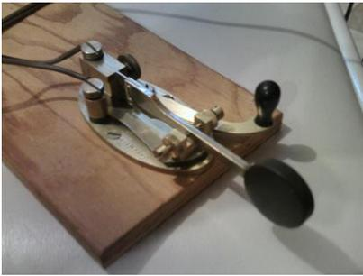
Tasto sideswiper o a lama di coltello. È un tasto manuale inventato per riposare il polso durante la trasmissione. I due poli suonano entrambi allo stesso modo e sarà l'operatore a decidere lunghezza e spaziatura. La leva a destra è per la regolazione dello spazio fra i poli di contatto.
