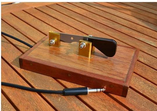
Sideswiper o a lama di coltello convertito a Paddle a mono pala. Da notare che è una autocostruzione dove è usato un coltello e a conferma dell'uso ad elettronico vi è il jack stereo.
