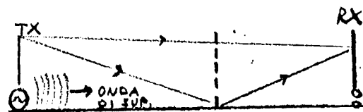
Onde di spazio e onda di superficie costituiscono l'onda di terra.
